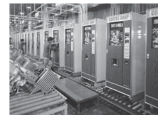
八尾工厂的自动售货机生产线（1976年）
