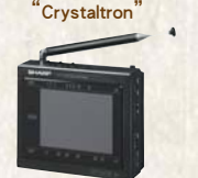
1987年 / 3C-E1 采用TFT方式的 液晶面板
